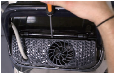
7.1. Za pomocą płaskiego śrubokrętu zdejmij kratkę ochronną.
